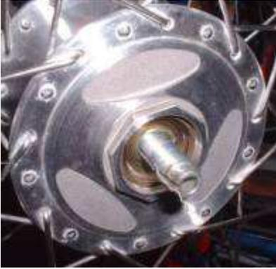
Besondere Sorgfalt ist bei der Demontage der rechten Lagerseite erforderlich. Schwachpunkt ist der dünne Kupferdraht, der den Pluspol des elektrischen Anschlusses mit Strom versorgt. Es ist unvermeidbar, den Draht bei den Arbeiten ein wenig zu biegen. Das sollte jedoch nur sehr vorsichtig erfolgen, da eine gewisse Bruchgefahr besteht.
