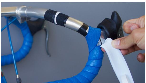
Greift das Lenkerband um die Bremse herum, jetzt ändert sich die Wickelrichtung. Es kommt unterhalb der Bremse heraus und wird nun an der Rückseite vorbei hoch gewickelt.
