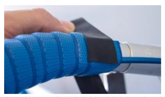
Klebt in Laufrichtung das Abschlussklebeband. Falls das Lenkerband zu lang ist schneidet den Rest ab.
