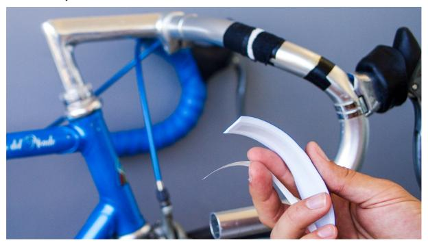
Löst das Klebeband auf der Rückseite des Lenkerbands.
