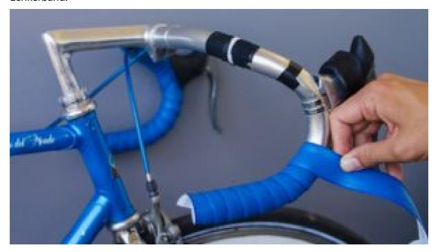
Wickelt das Lenkerband so bis zur Schelle der Bremse.
